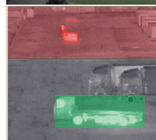
Les caméras thermiques détectent la présence d'une personne ou d'un véhicule dans la zone vidéosurveillée et transmettent le signal au système de commande de l'éclairage.
