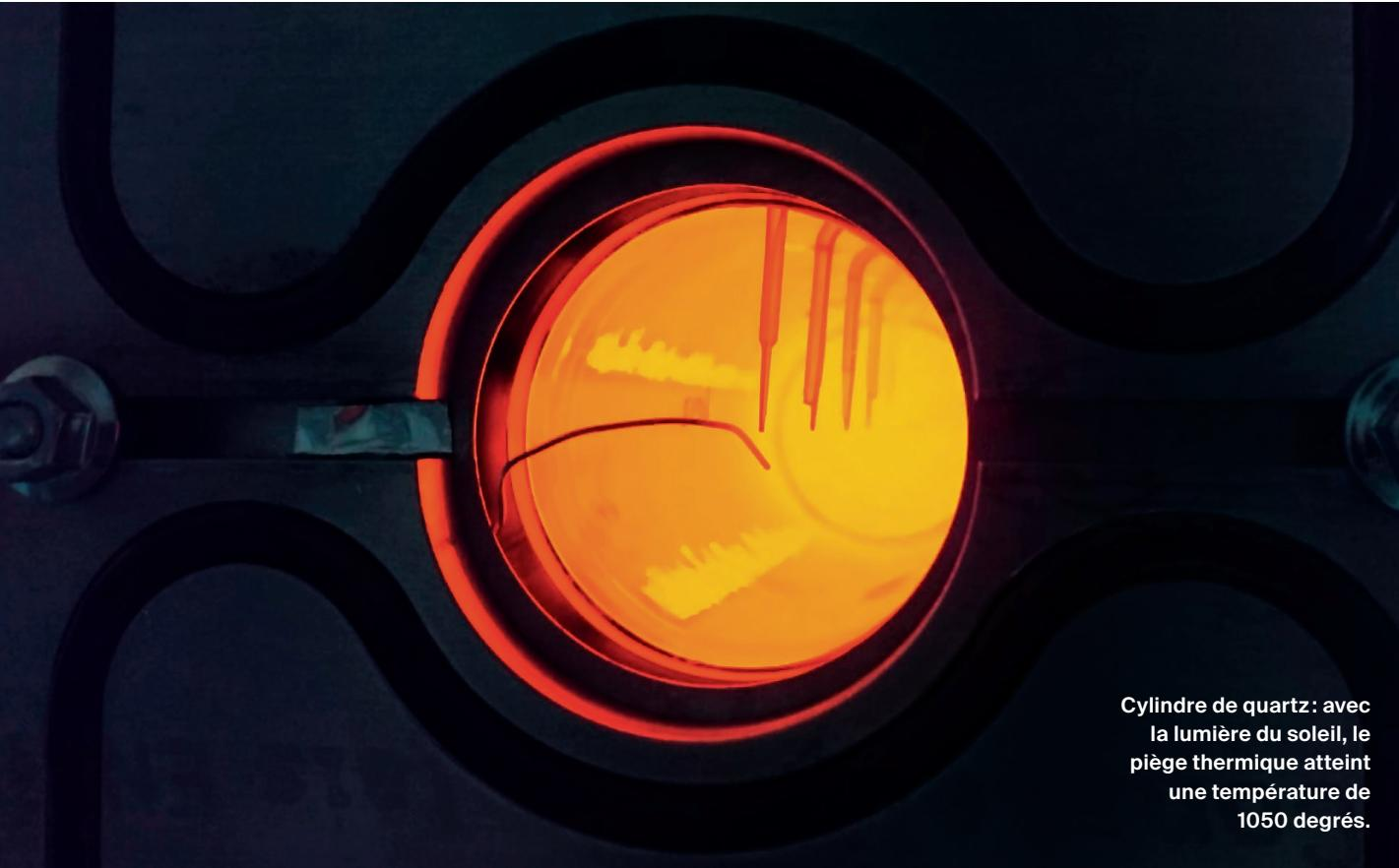
Cylindre de quartz: avec la lumière du soleil, le piège thermique atteint une température de 1050 degrés.
