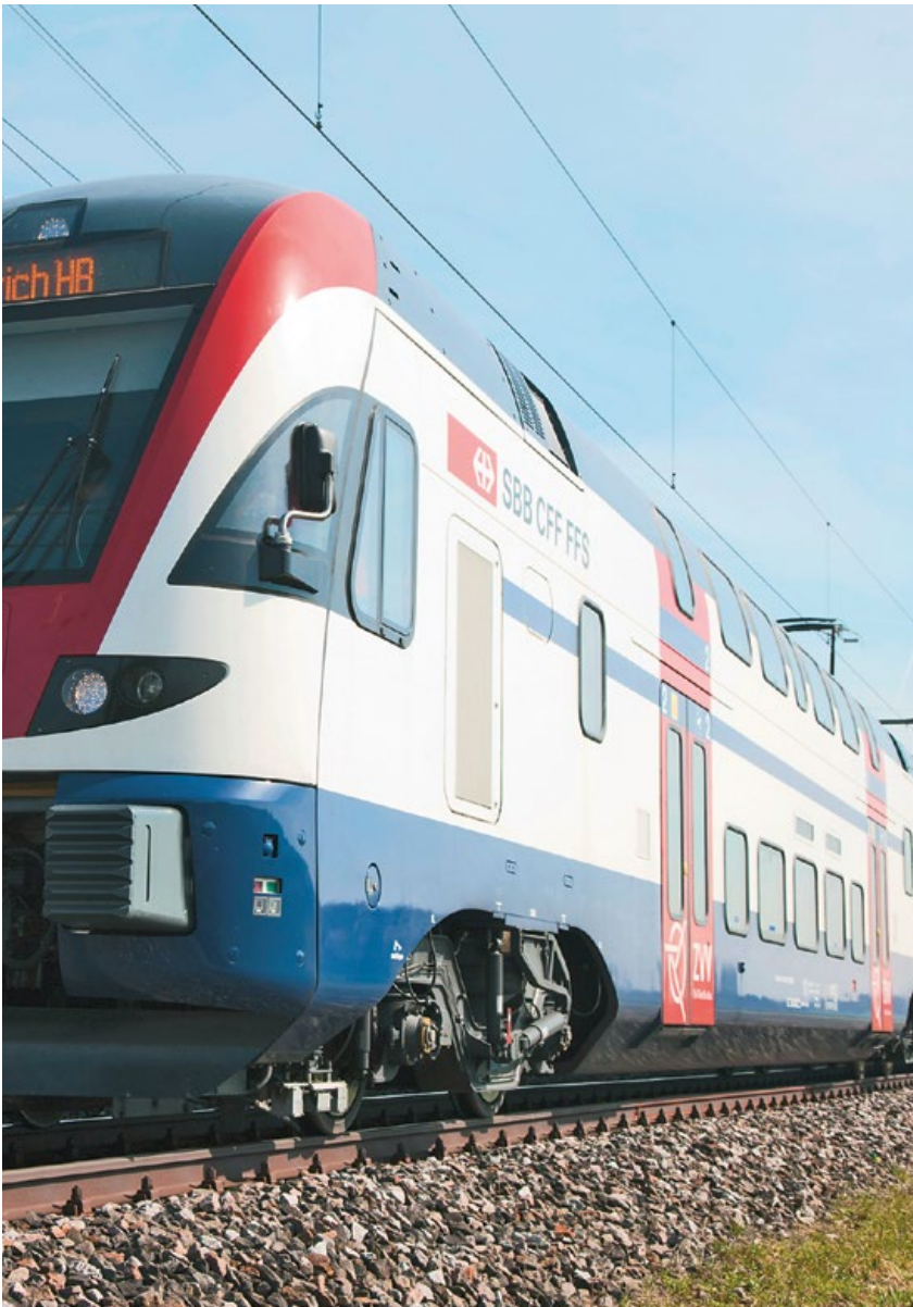
Le DTZ, la rame automotrice à deux étages du RER zurichois
